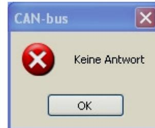
**Bild 20: Antrieb nicht angeschlossen oder nicht eingeschaltet, fehlender Abschlusswiderstand**
